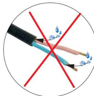
Asigurați-vă că utilizați un conector de cablu IP68. Schimbările de temperatură din piatră pot cauza atragerea umezelii prin izolație, ceea ce poate deteriora corpul de iluminat.
