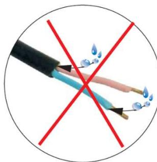
Utilisez impérativement un connecteur de câble IP68. Les changements de température dans la pierre peuvent entraîner l'absorption d'humidité par l'isolation, ce qui peut endommager le luminaire.
