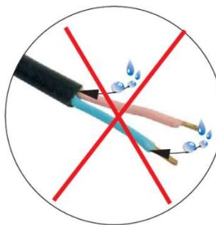
Assicurarsi di utilizzare un connettore per cavi IP68. Gli sbalzi di temperatura nella pietra possono far penetrare l'umidità attraverso l'isolamento, danneggiando l'apparecchio.
