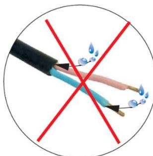
Nezapomeňte použít kabelový konektor s krytím IP68. Změny teploty v kamene mohou způsobit nasávání vlhkosti přes izolaci, což může svítidlo poškodit.
